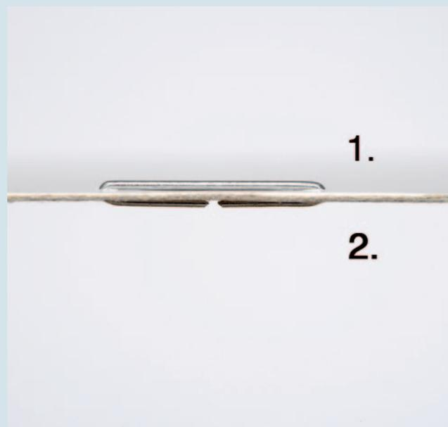
Mediante la nueva técnica de grapado en dos fases, las patas de la grapa penetran primero en el papel, después se doblan las patas, dejándolas absolutamente planas y prensadas contra el papel.
