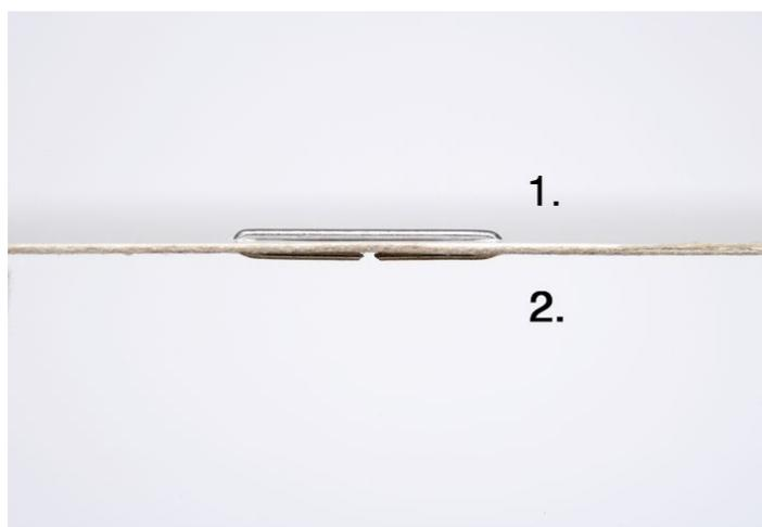
Mediante la nueva técnica de grapado en dos fases, las patas de la grapa penetran primero en el papel, después se doblan las patas, dejándolas absolutamente planas y prensadas contra el papel.
